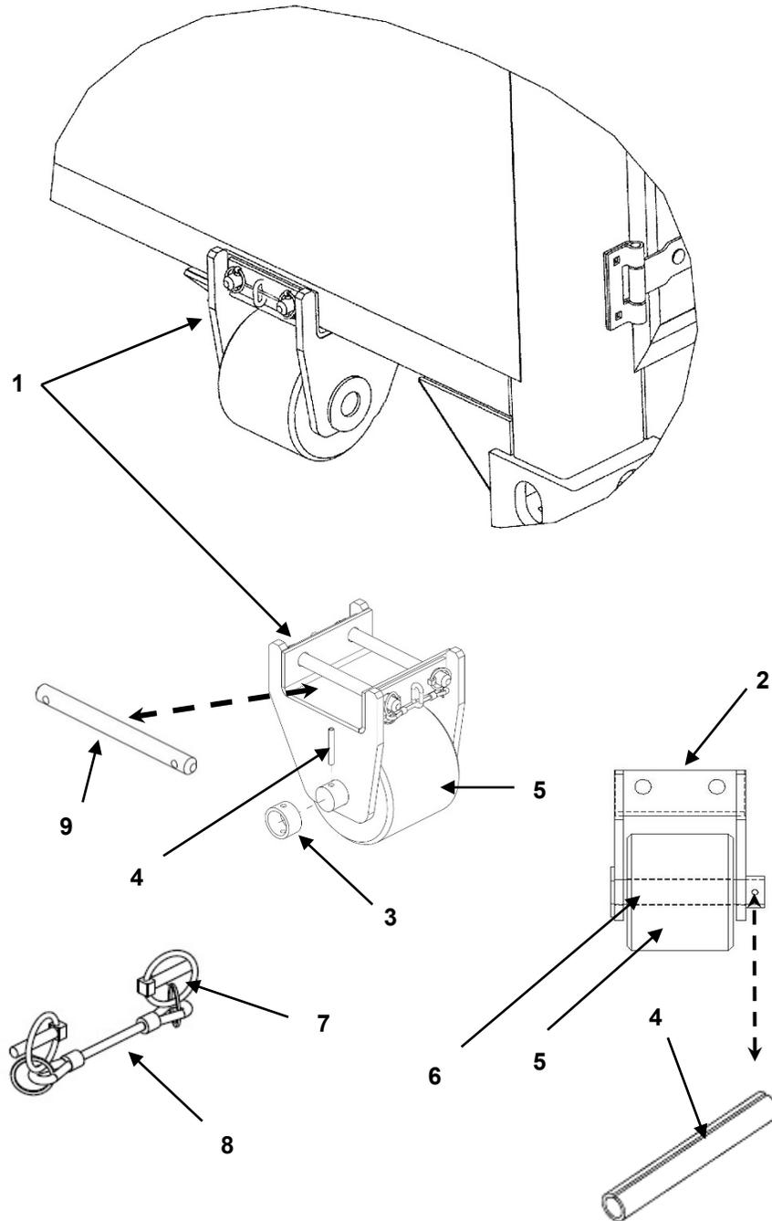
FIGURE 43 REAR ROLLER ASSEMBLY
