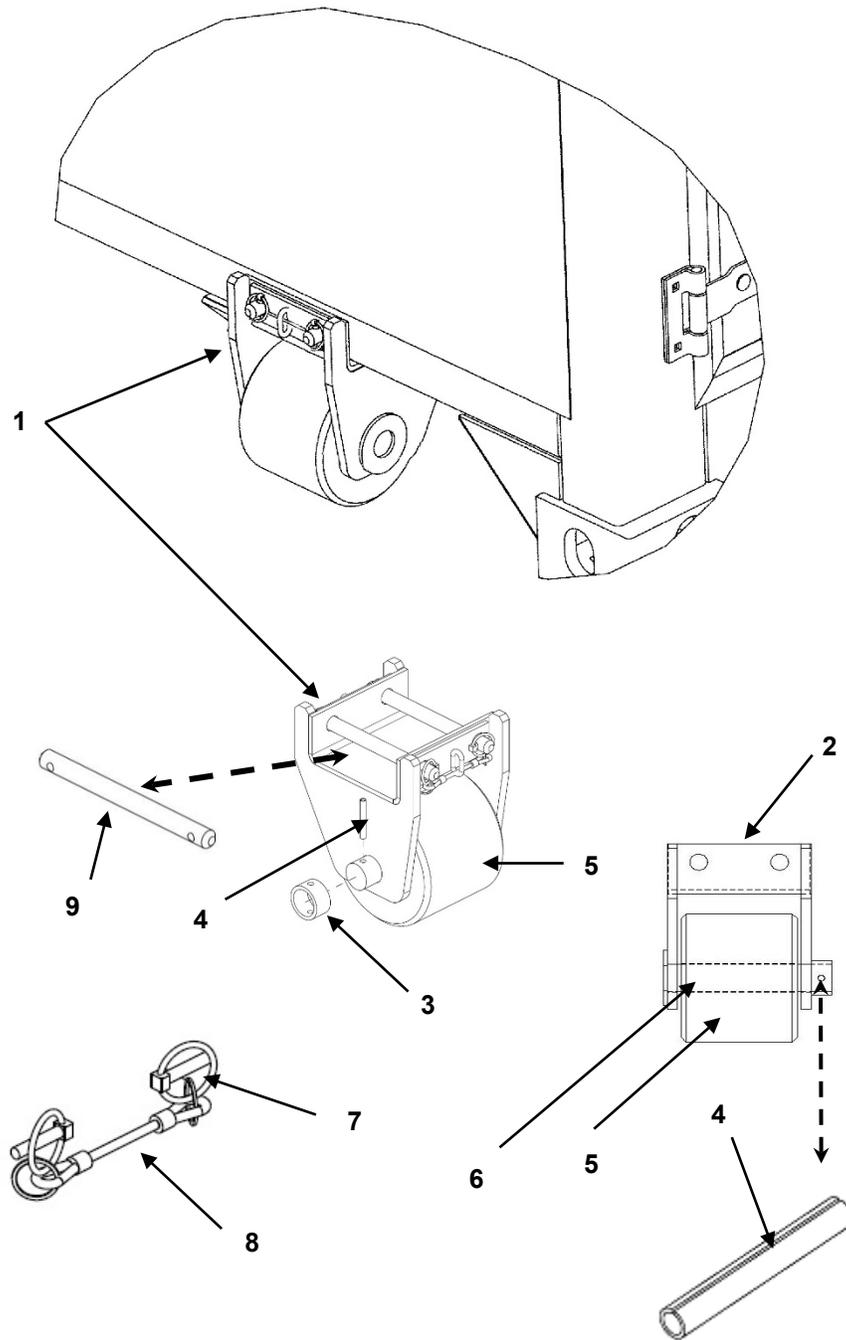
FIGURE 24 REAR ROLLER ASSEMBLY
