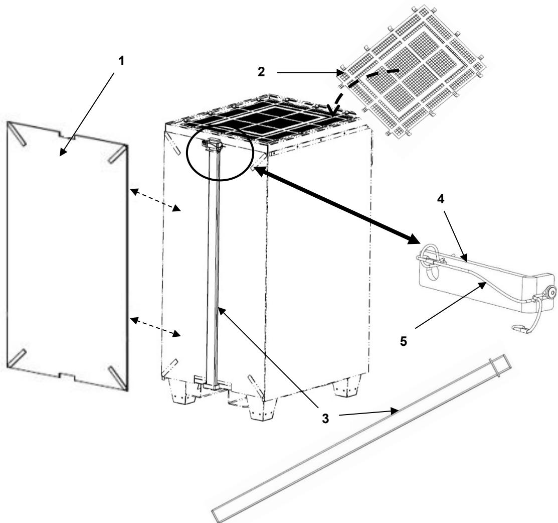
**FIGURE 28 STANDARD MODULE EXTERIOR PARTS**
