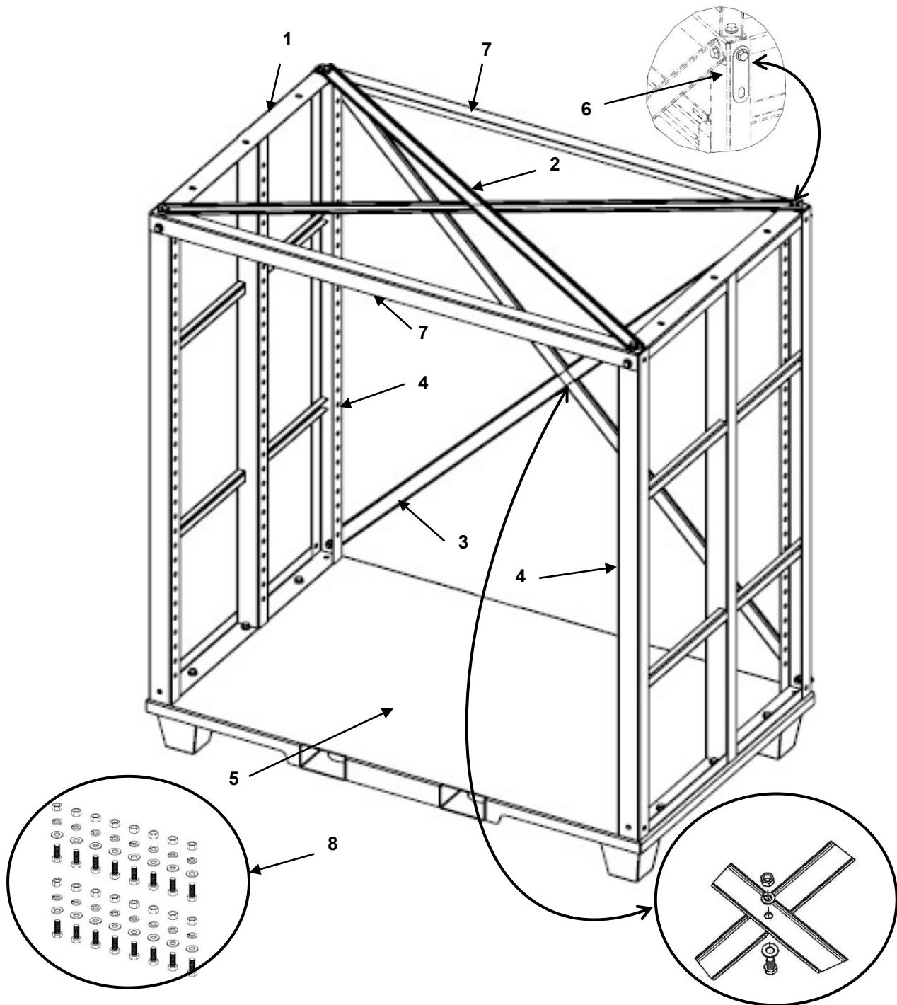
**FIGURE 36 BULK STORAGE MODULE CHASSIS**
