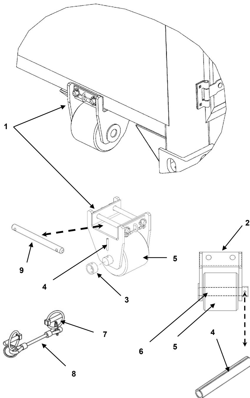
FIGURE 17 REAR ROLLER ASSEMBLY
